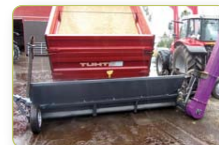
Täyttölaite-valssimylly Baggeria täyttämässä
