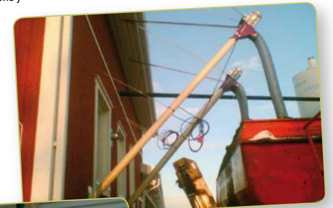
Suorasiirrokuljettimet apevaunun täytössä
